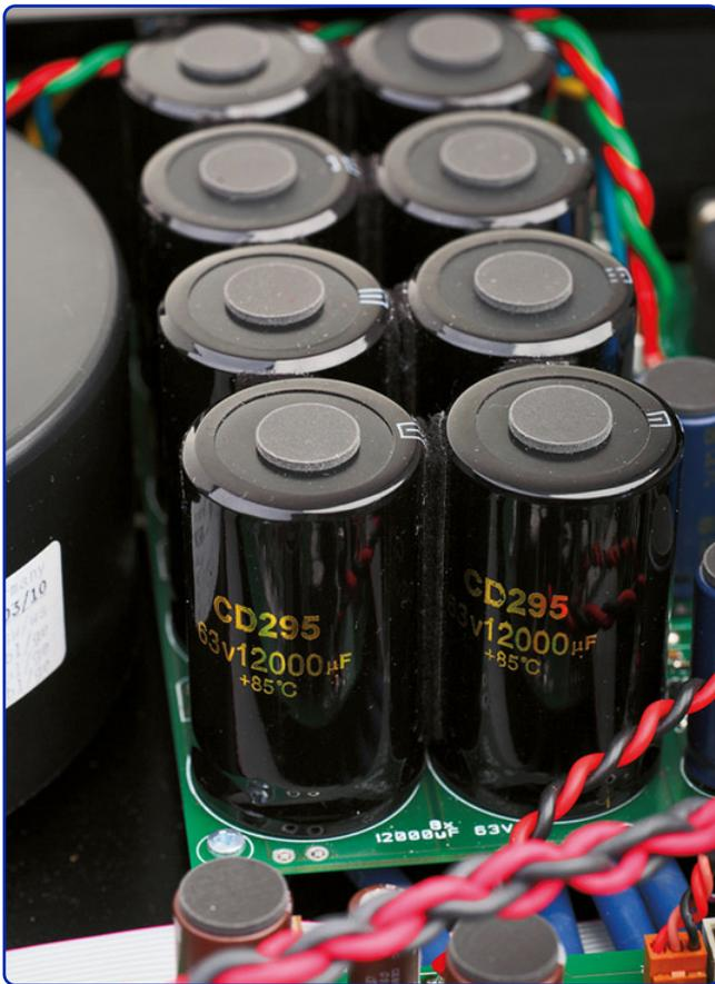
*Strom auf Vorrat: Im neuen G2 dienen acht Elkos der Pufferung von Strom, um sie bei Impulsspitzen blitzschnell abzurufen.*
