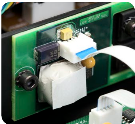
Eines der Geheimnisse überragender CD-Wiedergabe heißt „Jitter-Minimierung“, auch hierbei spielt Mechanik eine entscheidende Rolle. Deshalb sitzt der Low Jitter-Oszillator des ART G2 in Nähe des schwingend aufgehängten Laufwerks und wird zusätzlich bedämpft
