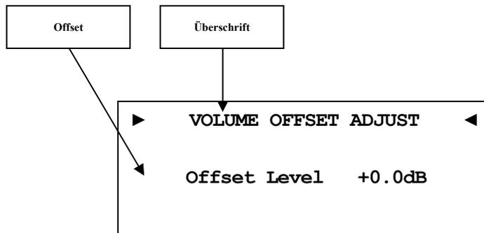
Um Lautstärkeunterschiede zwischen den Eingangsquellengeräten auszugleichen, kann jeder Eingangskanal im Bereich von -9dB...+9dB angepasst werden.
