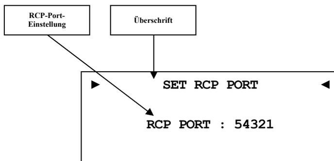
Der Kommunikationsport für die Software Audionet RCP bzw. für die Android App aMM wird hier eingestellt. Dieser Punkt kann bei Bedarf angepasst werden. Der eingestellte Wert muss zwischen 50000 und 59999 liegen. Werkseitig ist der Port 54321 eingestellt und muss nur verändert werden, falls dieser Port anderweitig in Ihrem Netzwerk belegt oder gespeichert ist. Fragen Sie bei Bedarf Ihren Netzwerkadministrator oder Computerfachmann.
