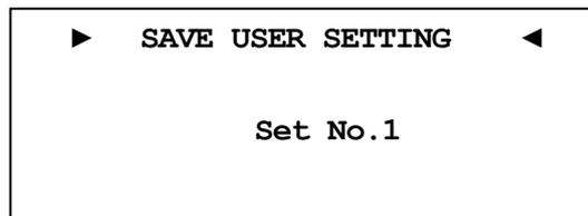
Öffnen Sie das Systemmenü mit der Taste **Menu** auf der Audionet Systemfernbedienung *Harmony One* oder durch langes Drücken der Taste **set** auf der Gerätefront. Navigieren Sie mit den Tasten Oben / Unten bzw. **up** / **down** zum Menüeintrag **Save User Setting**.
