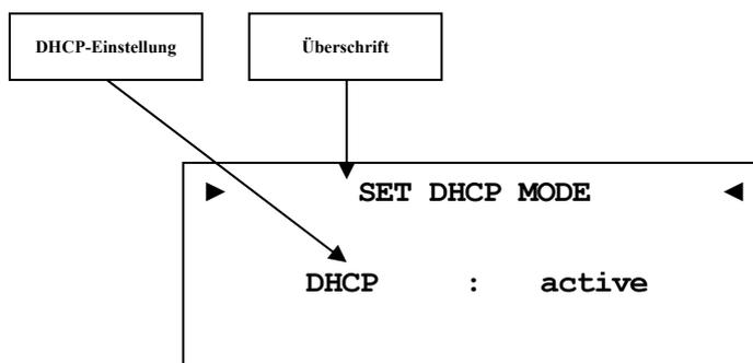
**active** Werkseinstellung. Der DNA wird die benötigten Verbindungsdaten über DHCP abfragen.
