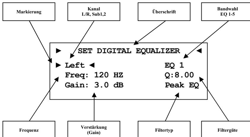
Die Navigation durch das Menü des digitalen EQ erfolgt mit dem Steuerkreuz der Fernbedienung. Mit den Hoch/Runter Tasten wählen Sie den zu
