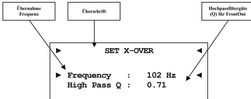
Stellen Sie die Übernahmefrequenz und die Güte der Hochpassfilter für die Lautsprecherkanäle Links und Rechts ein. Die Frequenzeinstellung gilt auch für die Tiefpassfilter der Subwooferausgänge.
