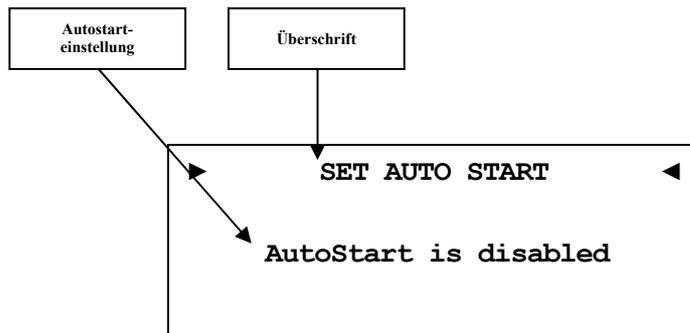
**disabled** Die Autostart-Funktion ist ausgeschaltet. Nach Einschalten des Gerätes mit dem Netzschalter **[8]**\* an der Geräte-rückseite, geht der DNA in den Stand-by-Modus. Erst ein Betätigen der Taste **power** an der Gerätefront bzw. der Taste **Power On** oder **Power Toggle** der Audionet Systemfernbedienung *Harmony One* schaltet das Gerät in den normalen Betriebszustand ein.
