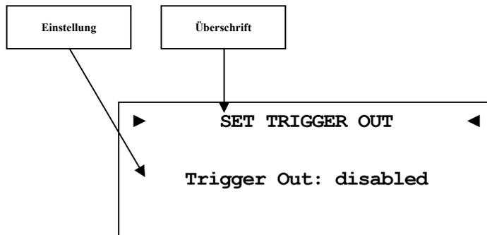
Der Trigger Out-Anschluss kann z.B. zum Ferneinschalten von Endstufen benutzt werden. Die werkseitig eingestellte Spannung ist 12V. Die Triggerspannung kann auch auf 5V umgestellt werden. Änderung der Triggerspannung darf nur durch qualifiziertes Fachpersonal erfolgen. Bitte fragen Sie Ihren Fachhändler.
