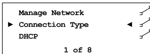
Wählen Sie mit den Steuerkreuztasten Links / Rechts den gewünschten Verbindungstyp. Es stehen **Wired Ethernet** und **Wireless (WiFi) 802.11** zur Auswahl. Bestätigen Sie mit **OK**.
