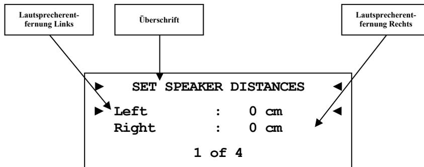
In diesem Menü stellen Sie die Entfernungen zwischen Ihrem Hörplatz und den entsprechenden Lautsprechern ein (**Speaker Distance**). Die einstellbare Distanz erstreckt sich von 0 bis 700 cm in Schritten von 5 cm. Der DNA berechnet aus diesen Angaben automatisch die nötige Verzögerung der Kanäle, so dass ein Schallereignis aus den Lautsprechern zeitgleich am Hörplatz eintrifft.
