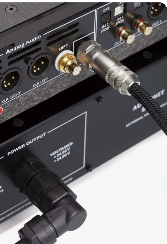
Die Verbindung zwischen ART G3 und EPX erfolgt über ein mitgeliefertes Spezialkabel. Beide Geräte werden mit Netzkabeln an das Stromnetz angeschlossen
